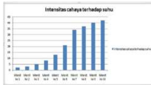
Gambar 4. Dampak Intensitas Cahaya terhadap Output Panel Sumber : Analisis Pribadi
